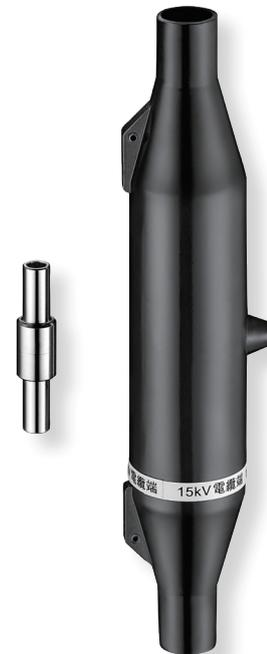
直線接頭由聚乙烯化合物 (EPDM) 一體模鑄成型製成，分為半導體性之內、外半導體層及絕緣能力極佳的絕緣層，半導體層之內襯部份與絕緣層緊密接合，擁有完善之電氣特性及防水設計。本產品全數經在廠測試電量及一分鐘交流耐壓合格後出貨，現場裝配時不需再包紮或補膠。產品經台灣電力公司認證合格。
