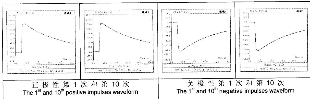
附录C 恒压负荷循环试验后组合试样冲击电压试验实际耐受电压值和冲击电压波形(室温下, 125 kV, 允许  $\pm 3\%$  偏差)
