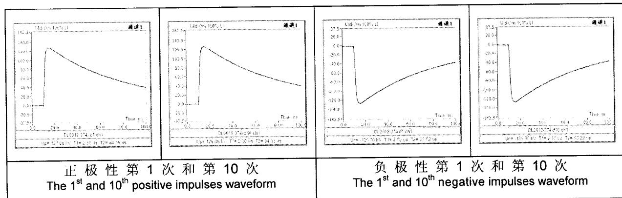
附录D 动热稳定试验后组合试样冲击电压试验实际耐受电压值(室温下, 125 kV, 允许±3%偏差)
