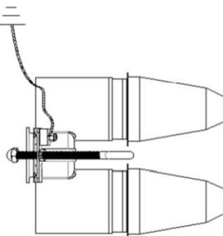
Conecte o fio de drenagem #14 AWG ou equivalente do lug de aterramento da bucha estacionária ao sistema de aterramento, e deixe uma folga suficiente para operar com o bastão de linha viva.
