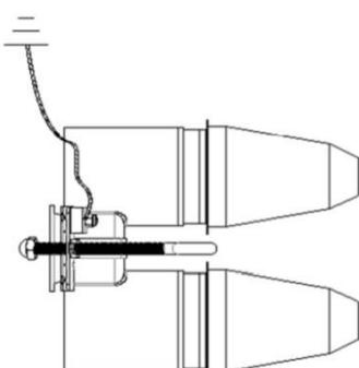
Conecte el cable de drenaje # 14 AWG o equivalente del terminal de conexión a tierra del buje estacionario al sistema de conexión a tierra, y deje suficiente espacio para operar con la varilla de línea viva.
