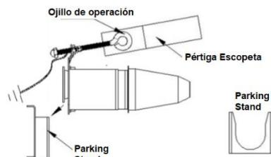
Usando una pértega, enganche la boquilla mediante su ojillo de operación, luego insértela en el "Parking Stand" de la caja derivadora o aparato donde se busca instalarla, una vez en posición, gire el ojillo de operación en dirección a las manecillas del reloj para fijar la boquilla.
